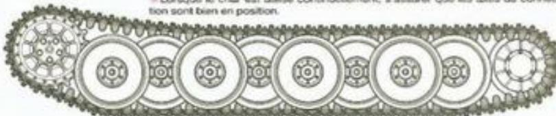
★テンション調整ネジでキャタピラの張りを調整します。ドライバーで右に回せば張り、左に回せばゆるみます。右図を参考に一度走行させてから一番よい位置に調整して下さい。
