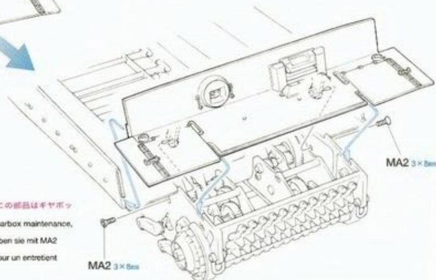
★前面装甲板は前側のツメに引っかけてMA2でサイドから固定します。この部品はギヤボックスのメンテナンスのため接着しません。
