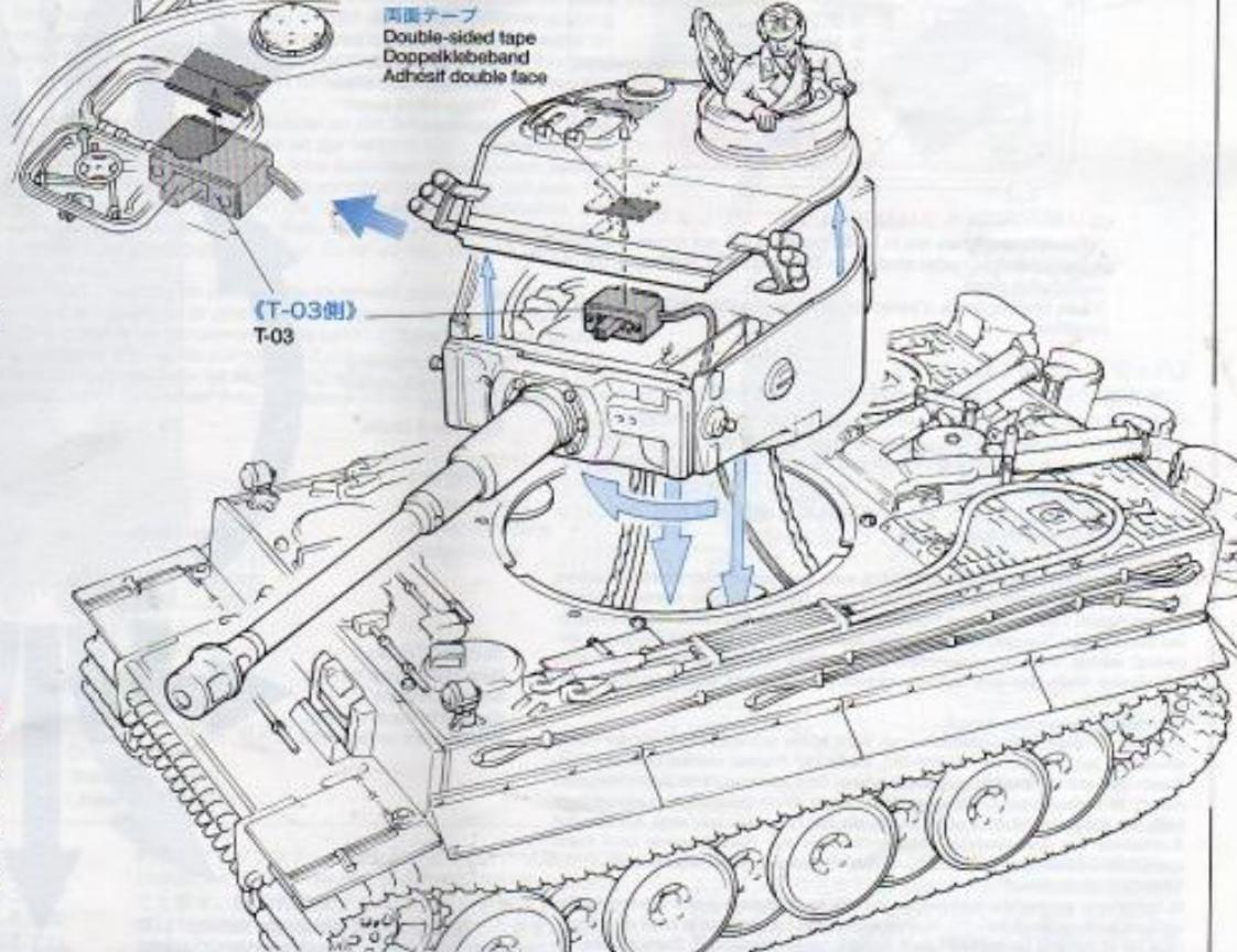
★車体の裏に砲塔の出っ張りを合わせて矢印の方向に回します。ガリガリと音がして砲塔がしっかりとはまった事を確認します。
