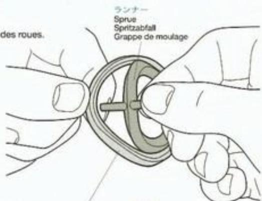
★MV1(輪輪用ラバー)には左図のようなランナーがついています。同を参考に全て取り除いてください。また輪輪(A4～A9)は輪輪用ラバーを取り付ける前に塗装します。
