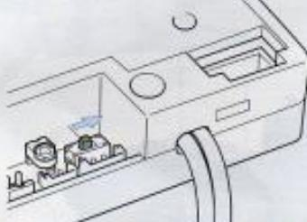
次にMF-01側のSW3スイッチをON(右側)にします。すると各ユニットが一斉にセルフチェック作動します。(各ユニットが順に動き出すので注意してください。)各ユニットが作動中はMF-01の作動インジケーターがグリーン、レッドの点滅を繰り返します。この状態であればMF-01は正常です。インジケーターが点滅しなかったり、各ユニットが作動しない時は修理が必要です。
