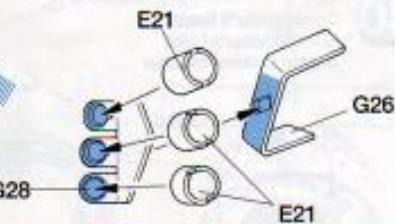
★スマートディスチャージャーは砲塔側には接着せずに砲塔上板にしっかりと接着します。この時砲塔側に接着剤が付くと砲塔上板がはずれなくなるので注意しましょう。
