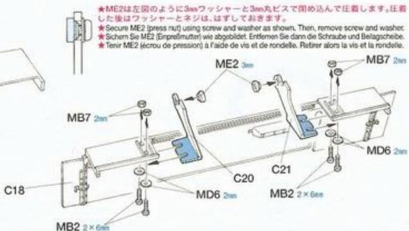
★ME2は左図のように3mmワッシャーと3mm丸ビスで閉め込んで仕上げします。仕上げた後はワッシャーとネジは、はずしておきます。
