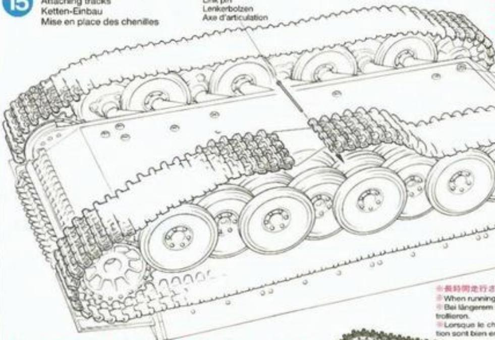
★キャタピラは連結ピンが必ず内側にくるように取り付けます。
