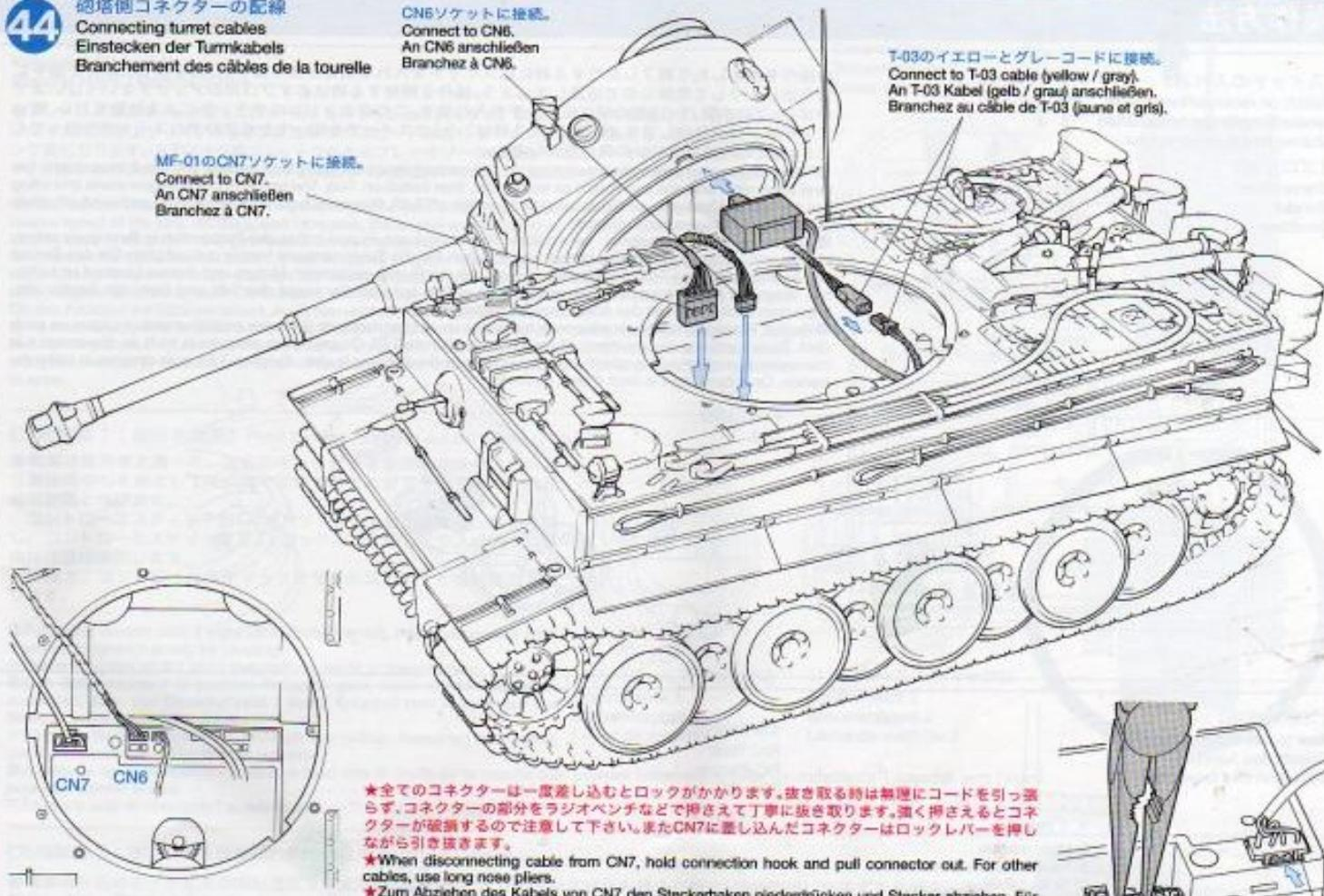
★全てのコネクターは一度差し込むとロックがかかります。抜き取る時は無理にコードを引っ張らず、コネクターの部分をラジオペンチなどで押されて丁寧に抜き取ります。強く押されるとコネクターが破損するので注意して下さい。またCN7に差し込んだコネクターはロックレバーを押しながら引き抜きます。
